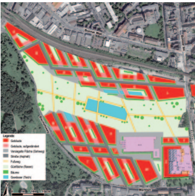
Abb. 5.2: Optimierter Planentwurf des ENVI-met-Simulationsgebietes „Großmarkt“ in Köln-Raderberg (Darstellung mit 4,2° Nordabweichung. Bildquelle: GeoServer NRW der IT.NRW (2012), Luftbildstand: 20.08.2010).
