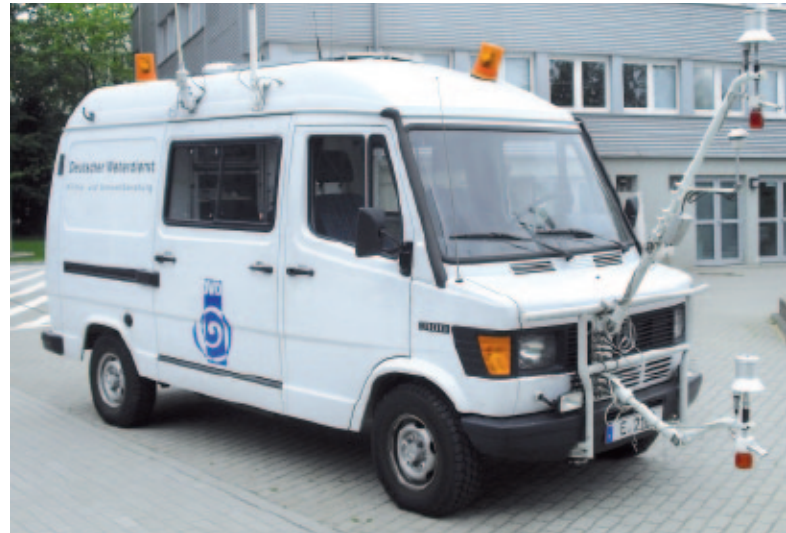
Abb. 3.6: Messfahrzeug des Deutschen Wetterdienstes Essen mit montierten Auslegern zur Messung von Temperatur und Feuchte in zwei verschiedenen Höhen.
