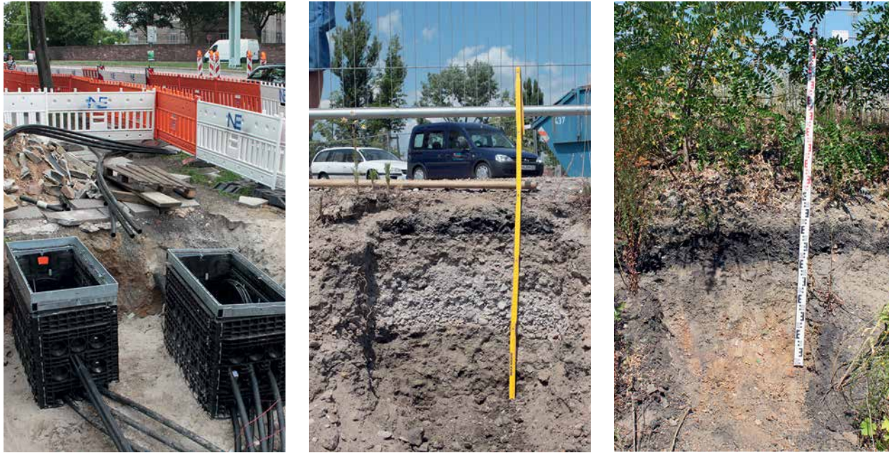
ABBILDUNG 3.5–2 ▶ Städtebau vernichtet natürlich gewachsene Böden und neue Böden bilden sich aus umgelagerten und technogenen Materialien. Links: Bodenarbeiten für eine Kabelverlegung. Mitte: Boden unter einer Straße mit grauer Zementschicht. Rechts: Schlackeschicht (schwarz) im Boden eines ehemaligen Rangierbahnhofs. (Fotos: aus Karlsruhe, Stefan Norra)
